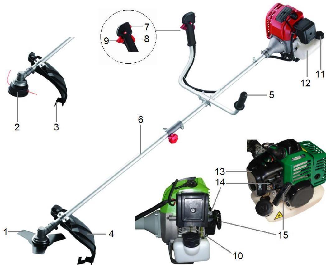
1. **LAME:** Lame à 3 dents pour l'herbe et les opérations de désherbage et débroussaillage. Un harnais et une protection plastique(4) sont nécessaires pour toute manipulation impliquant l'usage de la lame.
